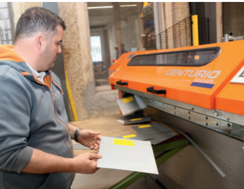
Das Bandblech wird in Längsstreifen gespalten, mittels einer Rollenschere quergeteilt und bei Bedarf gekennzeichnet.
