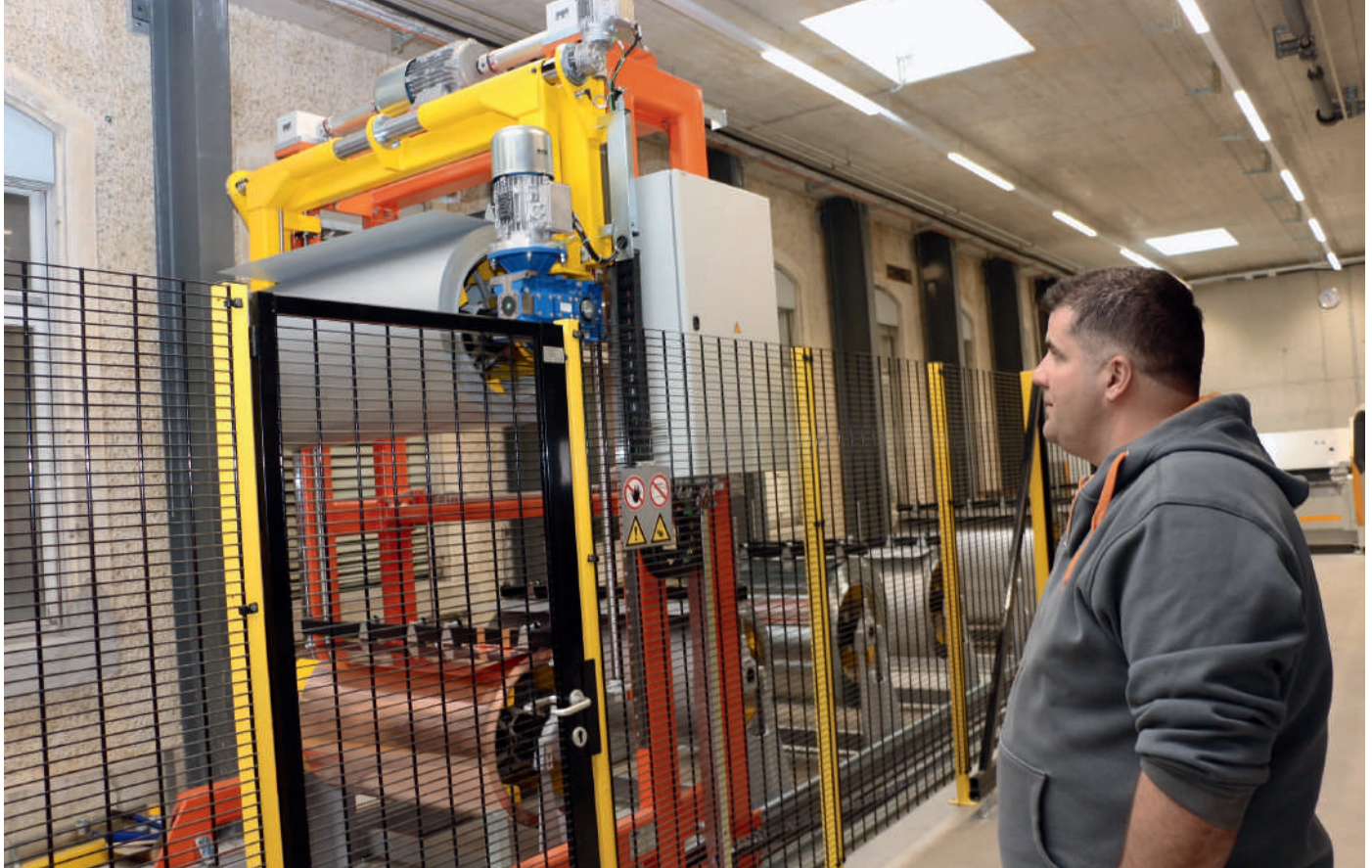
Das einzelne Coil wird vollautomatisch zur Schneidemaschine transportiert und mittels patentierter Vorrichtung in die Schneidemaschine eingespannt.
